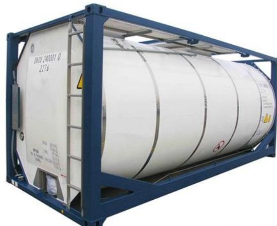
شکل ۳-۲- کانتینر مخزن‌دار برای حمل سوخت و مایعات خطرناک
